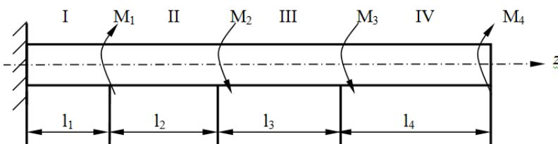
2.3. (ОПК-3) Для заданной балки требуется определить опорные реакции.
