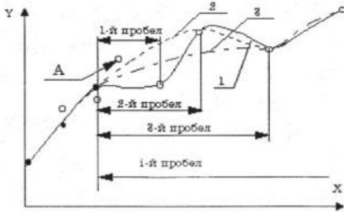
Рисунок 2 - Графическая модель сплайна
