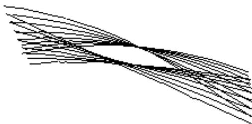
Рисунок 3 - Проверка плавности сечений пера
