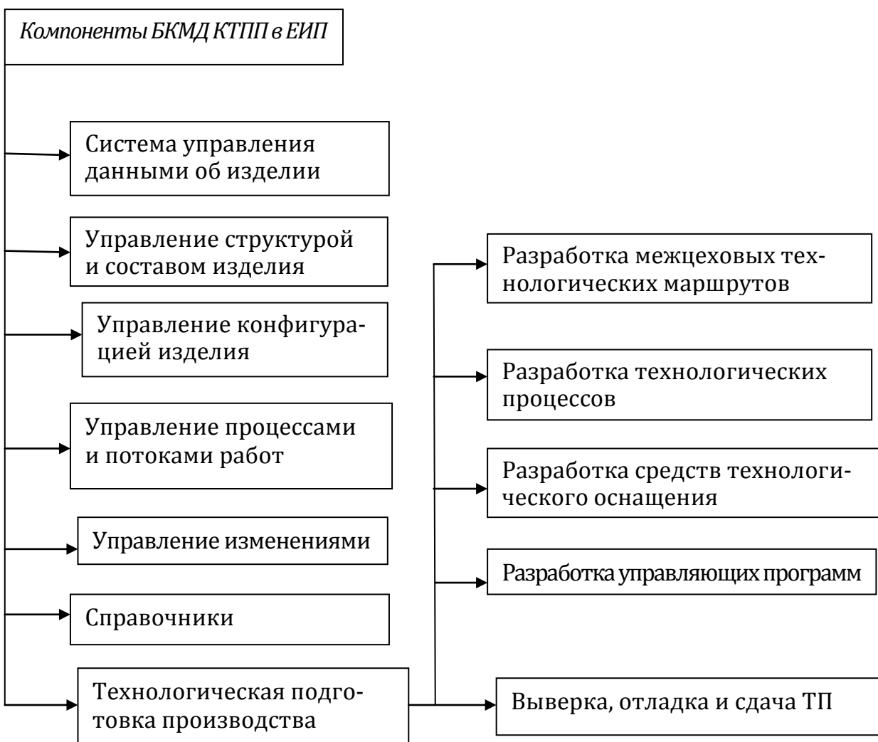
Рис. 1. Общий вид БКМД КТПП в ЕИП
