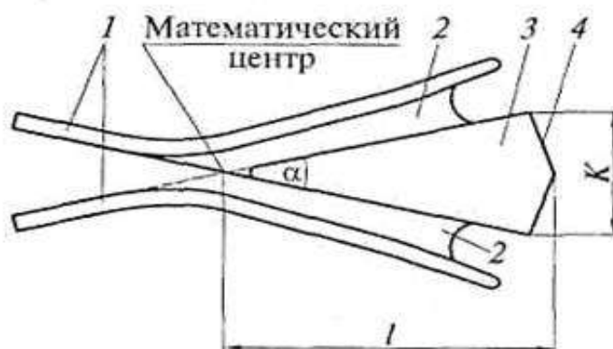
Рис. 2. Схема крестовины, где: 1 — усовики; 2 — желоба; 3 — сердечник; 4 — хвост крестовины; K — ширина сердечника крестовины; l — длина сердечника крестовины; \alpha — угол крестовины
