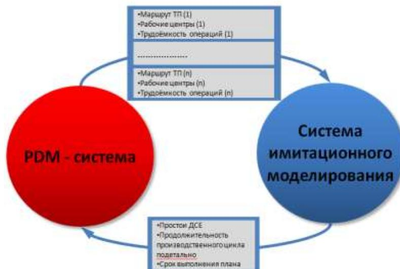
Рис. 1. Схема взаимодействия системы управления данными продукции системы имитационного моделирования
