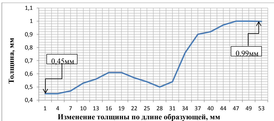
Рисунок 5 – Значение толщины детали при вытяжке с жестким прижимом и матрицей, усилие на прижим 35МПа ( S_0 = 1\text{мм}, D_{\text{заг}} = 108\text{мм}, d_{\text{фл}} = 106,7\text{мм} )
