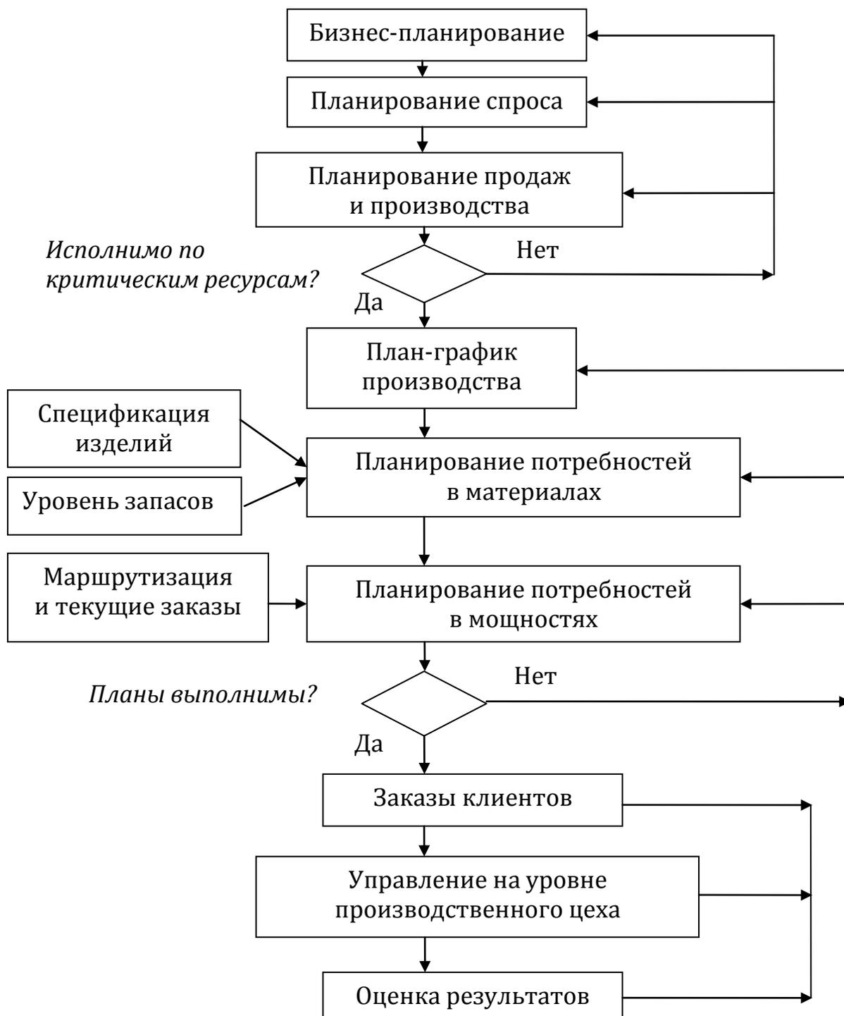
Рис. 1. Алгоритм управления предприятием в соответствии со стандартом MRP II
